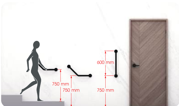
รูปแบบการติดตั้งบนพื้นที่ต่ำระดับ และพื้นราบ
